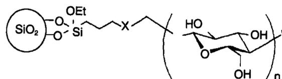
图 3 糖固定相结构示意图
